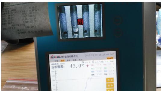
此样品的熔点为 40-43℃，JH80 全自动熔点仪测试的数据是 41.5℃，测试为合格。
